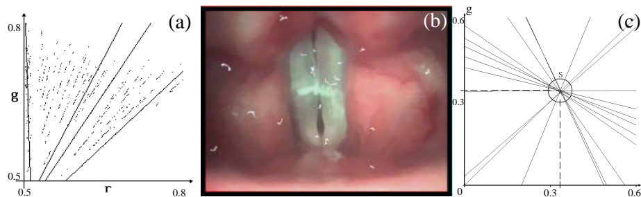
Abb. 1. (a) Ausschnitt des CIE-Farbdiagramms eines Clusters. (b) Die lokalen Pfade der repräsentativen Farbgerade eines Clusters sind als weiße Schlangenlinien im Farbbild eingetragen. (c) Die Farbgeraden der einzelnen Cluster schneiden sich in der Lichtquellenfarbe S.
